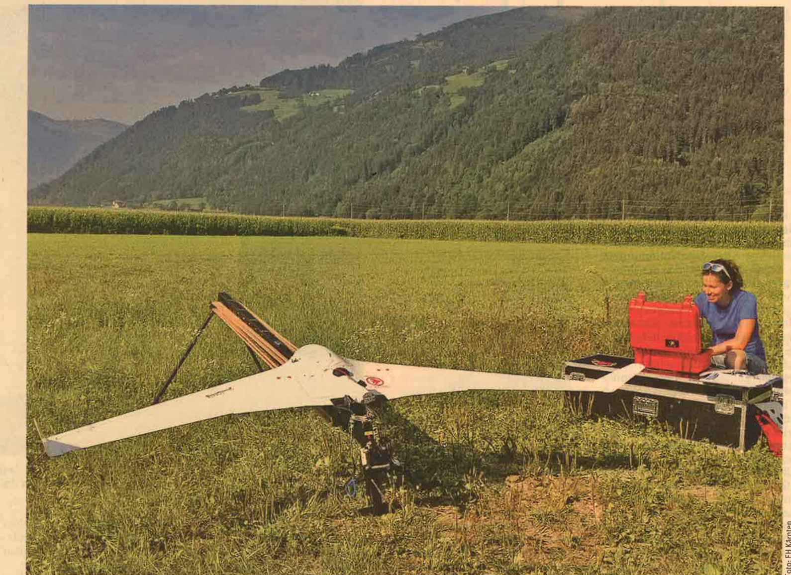
Die Sensordrohne, die im Rahmen des Projekts RPAMSS entwickelt wird, kurz vor dem Start. Während des Fluges über rückgebaute Flussabschnitte sammeln mehrere Kameramodule Daten über Veränderungen der ufernahen Pflanzenwelt.
